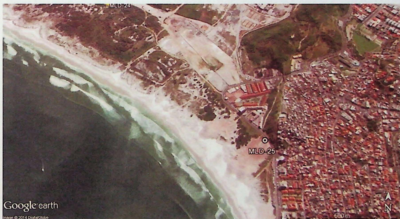
Figura 11: Lobo de blowout ativo rumo NE sobre paleodunas, no ponto MLD-25, extremo leste da barreira, junto à zona urbana de Arraial do Cabo.
